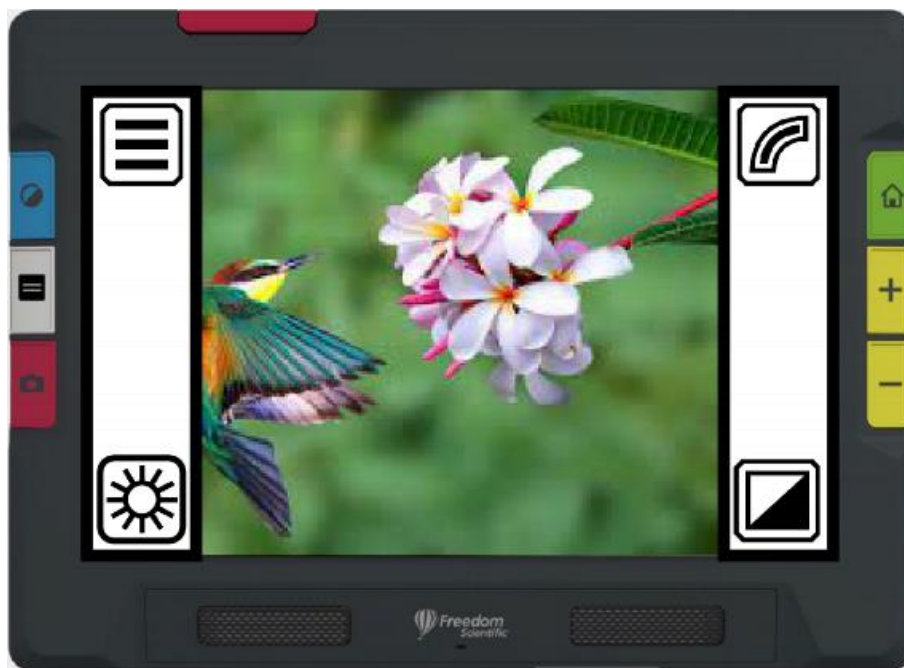
Rysunek. Przykład prezentujący przyciski wyświetlane podczas korzystania z kamery powiększającej w trybie zaawansowanym.
