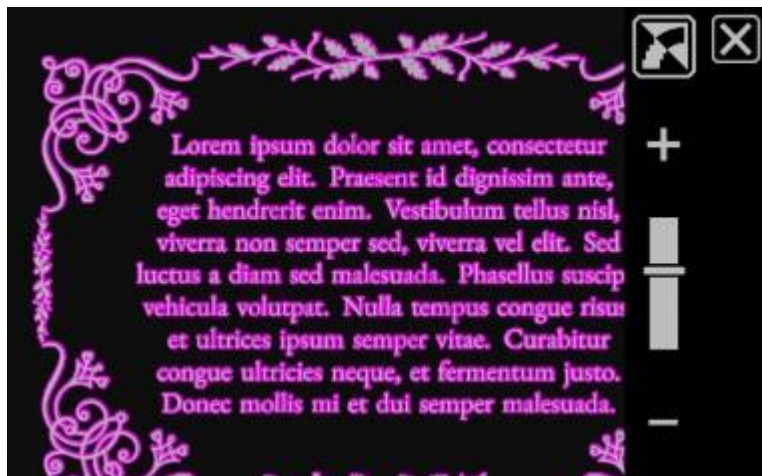
Rysunek. Przykładowy obraz w wysokim kontraście z podświetlonymi krawędziami. Dotknięcie przycisku nad suwakiem wyświetli ten obraz z wygładzonymi krawędziami.
